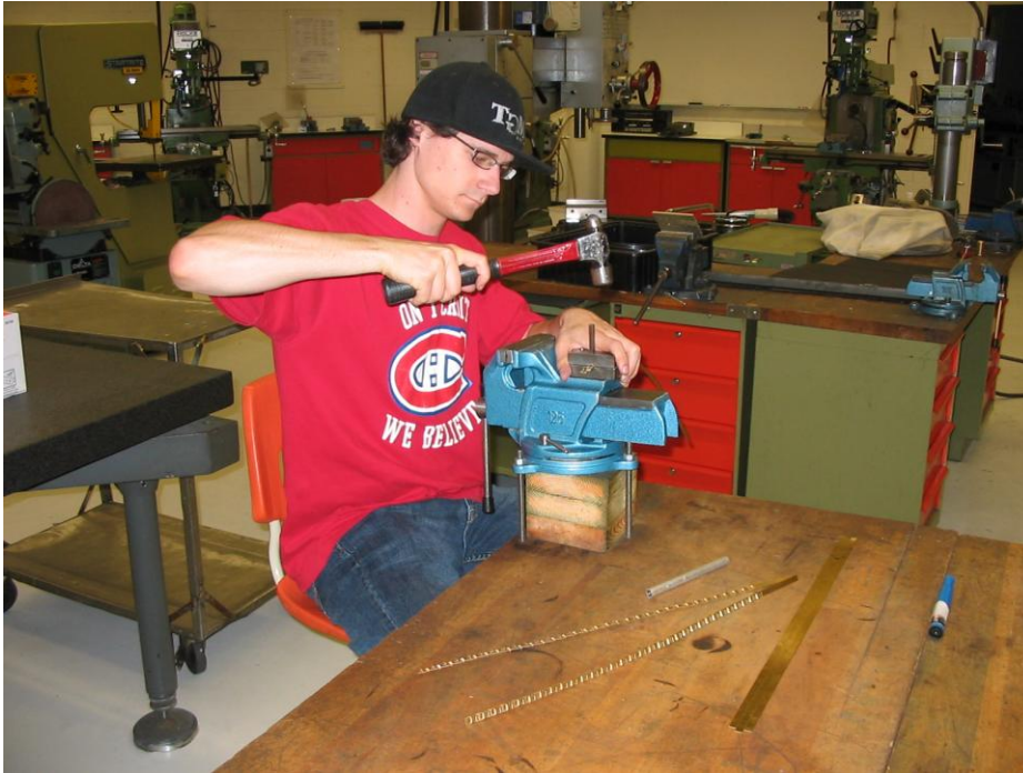
Figure 3.6-2 : Fabrication des inserts initiateurs de turbulence.
