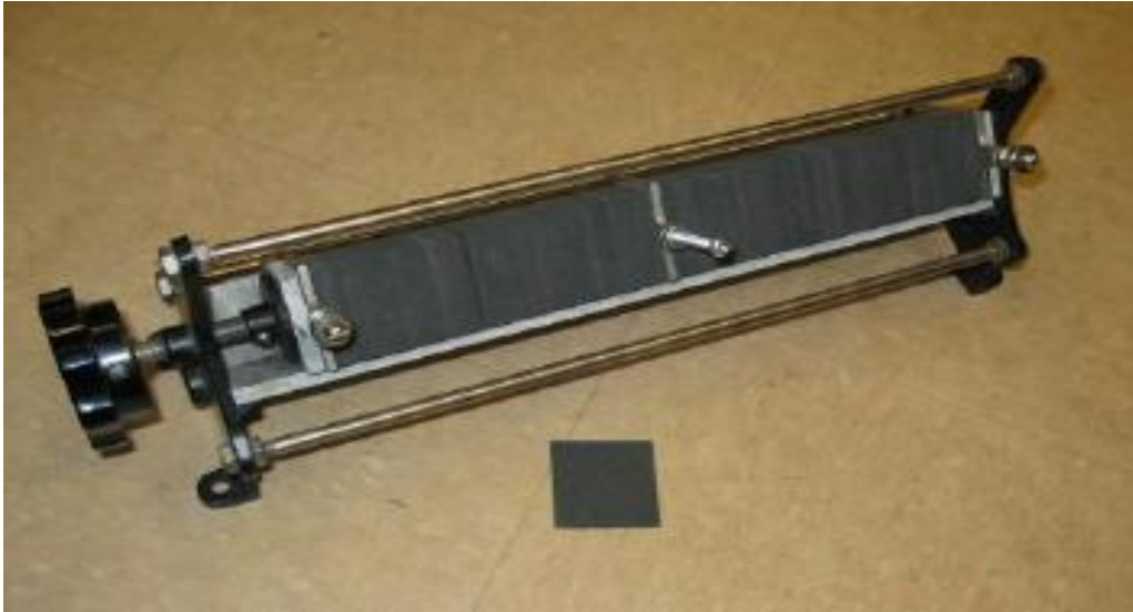
Figure 3.4-1 : Rhéostat à compression plaque de carbone utilisé pour faire varier la résistance externe imposée sur le générateur thermoélectrique.
